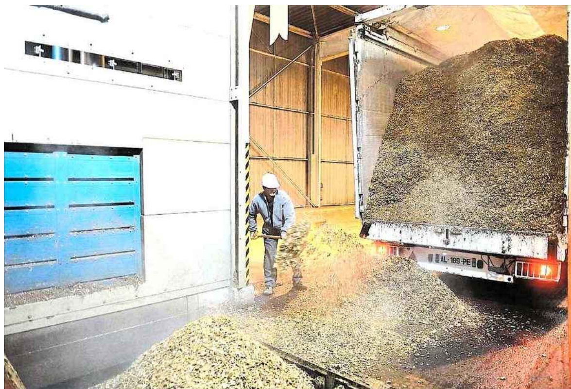
Angers, chaufferie bois Blowatts, janvier 2014. Inaugurée en mars 2013, la chaufferie collective de la Roseraie Blowatts utilise 90 000 tonnes de bois-énergie par an. 14 à 16 semi-remorques acheminent les copeaux chaque jour.
